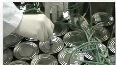
Las soluciones de **TMI-Orion** se basan en registradores de datos (Data Logger) autónomos integrados ubicados dentro de los procesos.
