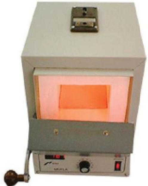
Diseñada para una gran variedad de aplicaciones, incluyendo trabajos de laboratorio, procesos a temperatura controlada, tratamientos térmicos, secado y calcinación de precipitados, pruebas de fundición. Con control analógico e indicador digital de temperatura. Rango de temperatura hasta 1,100 °C. fabricada en una sola medida.
