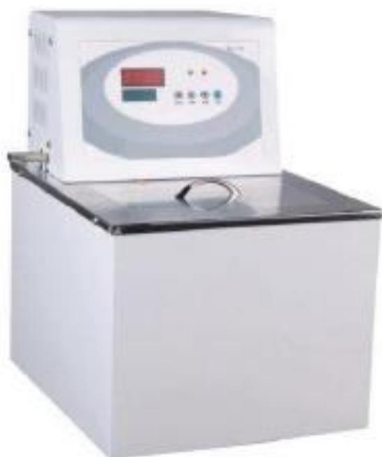
Los baños de agua con temperatura constante están equipados con un microprocesador de sistema de control inteligente, bomba de circulación, puede dejar fluir el líquido caliente desde el tanque y en consecuencia establecer un segundo campo constante de temperatura.
