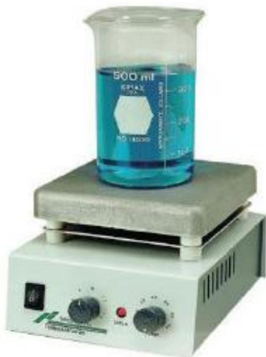
Para una eficiente agitación calentamiento, diseñados para operar a una temperatura máxima de 400°C. Ideal para laboratorios,
